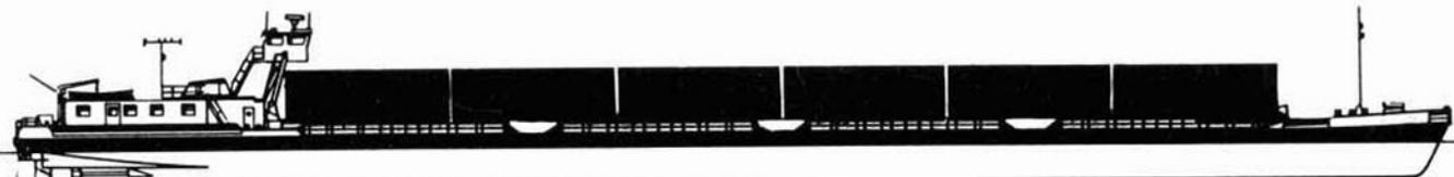
Motorgüterschiff – Einraumschiff zum Transport von Massengütern und bis zu 96 Containern zu 40 Fuß.
